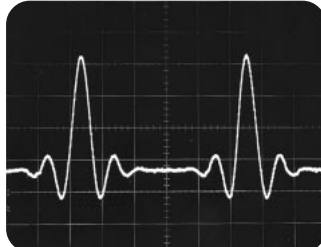
シーケンスモード(C.Cモード、ファーストモード) H:5ms / DIV, V:10A / DIV
